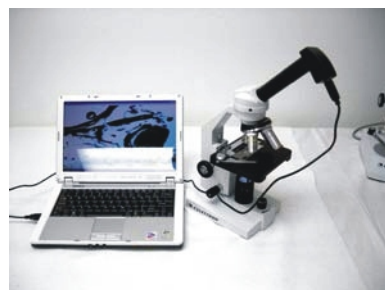
Digitális kamera egy hagyományos mikroszkóphoz csatolva
